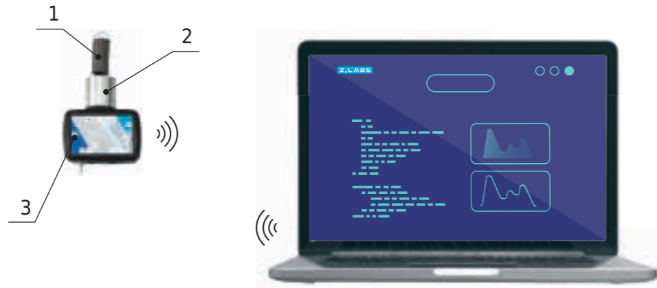
Схема установки: 1 – пружина, 2 – груз, 3 – датчик ускорения
